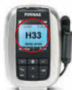
En el caso de que el receptor reciba interferencias de otros sistemas, el cambio de frecuencia de transmisión puede ser la solución al problema. Los transmisores más modernos tienen la opción de búsqueda de canales sin interferencia de manera automática.
