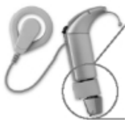
Figura 4 Receptor del sistema FM acoplado al procesador retroauricular del implante coclear. (Por cortesía de Phonak AG.)
